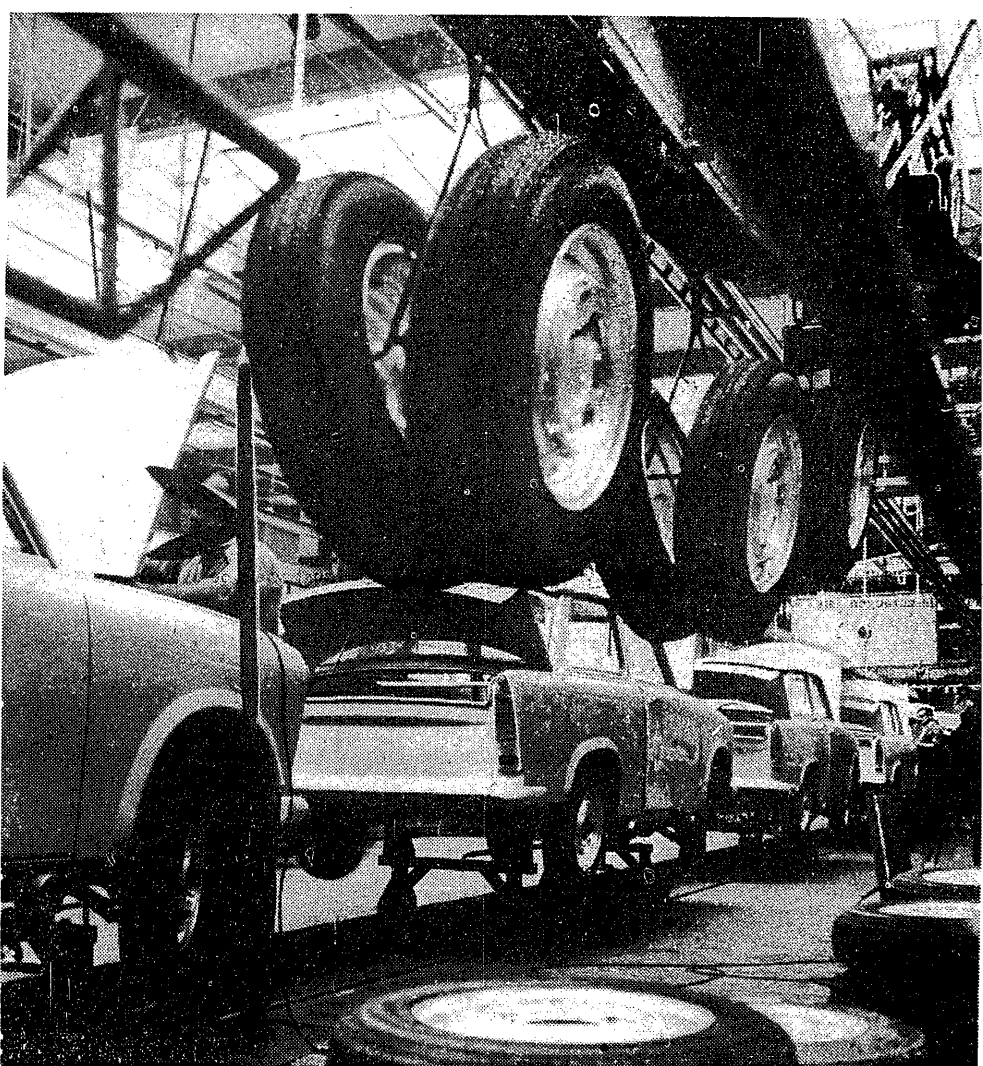
Linia transportująca opony do Trabanta „601” w zakładach samochodowych w Zwickau. Patrzący z lewej: Jerzy Bielecki i Karol Szwarc — Dostosowanie do aktualnych potrzeb str. 1 i 11.
